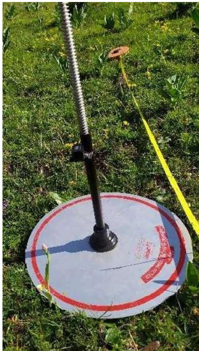
Des relevés de hauteur d'herbe sont effectués pour suivre la production fourragère. La quantité de fourrage disponible est appréciée par la mesure avec un herbomètre (figure 9). Le protocole est décrit dans la fiche d'information ADCF 4.2.6 (Information ADCF, 2004).
