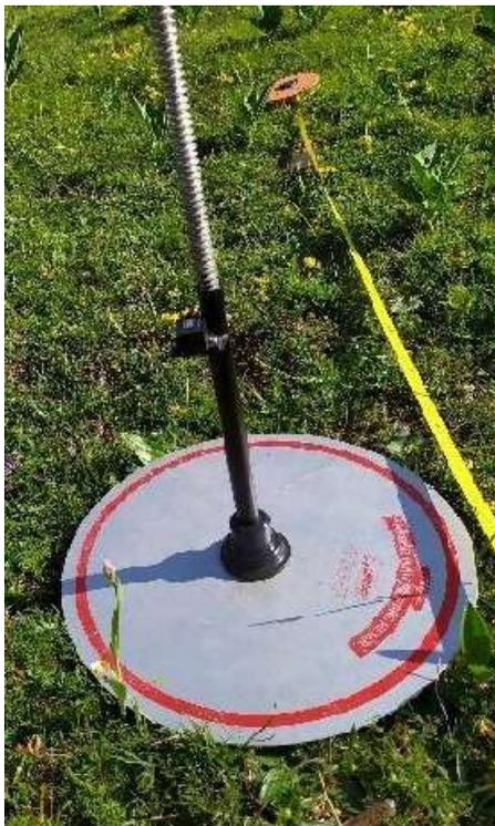
Des relevés de hauteur d'herbe sont effectués pour suivre la production fourragère. La quantité de fourrage disponible est appréciée par la mesure avec un herbomètre (figure 15). Le protocole est décrit dans la fiche d'information ADCF 4.2.6 (Information ADCF, 2004).
